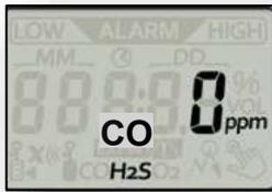
Lorsque le détecteur est en mode de fonctionnement normal, le type de gaz détecté est affiché en permanence. La concentration de gaz détecté est affichée jusqu'à ce qu'une touche soit actionnée ou qu'un événement d'erreur ou d'alarme « gaz » se produise.
